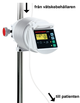
Bild 13: ASTOTHERM PLUS förberedd (utan ASTOLINE och utan värmeskyddsmanschett)
