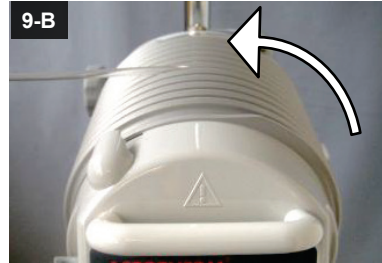
Kuva 9: Infuusioletkun asettaminen (aloitus)
