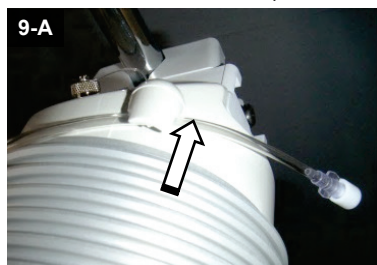
图 9: 铺设输液延伸管 (开始)
