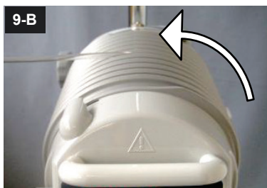
图 9: 铺设输液延伸管 (开始)
