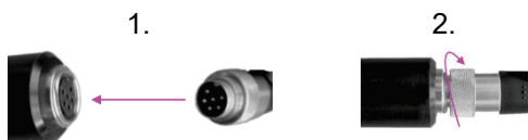
Imagen 7 Conexión del perfil térmico
